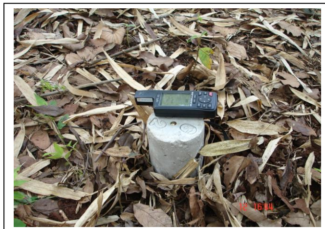
ภาพที่ 26 การสำรวจหาพื้นที่เป้าหมายในพื้นที่ด้วยเครื่องกำหนดตำแหน่งโดยใช้ดาวเทียม
